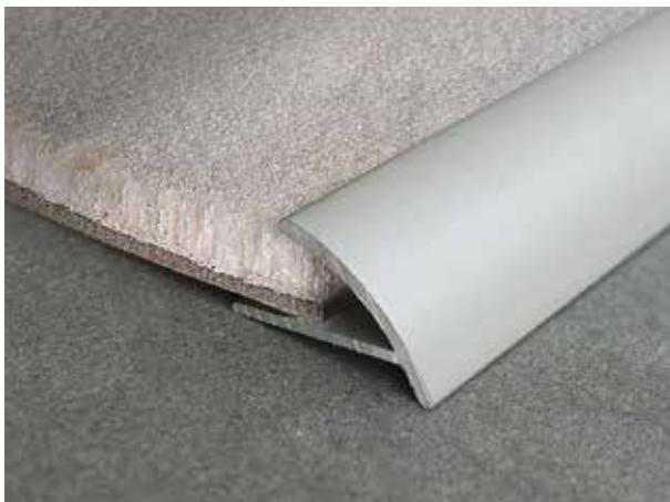
Terminales para pavimentos flexibles como moquetas o fibra de coco. Los perfiles, apretándolos, se cierran aprisionando el pavimento de manera duradera cubriendo los defectos de corte y preservando el borde.
